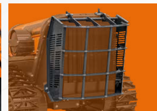
Protezione radiatore in acciaio Steel radiator protection
