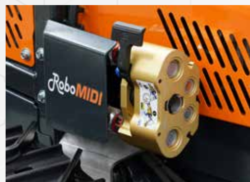
Attacchi rapidi idraulici CEJN CEJN fast hydraulic couplings
