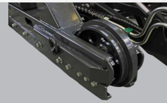
Обтегач на веригата с предпазна пружина Track tensioner with safety spring
