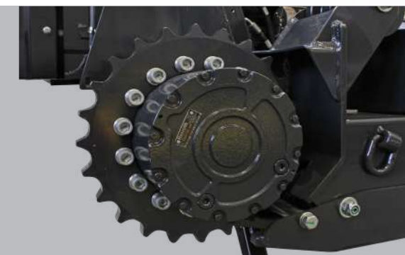
Зъбно колело на предаване към веригите от закалена стомана Gear wheel of transmission to the tracks in hardened steel
